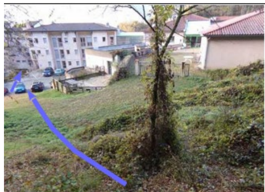
Figure 3.27: débouché de la combe de La Frau à l'amont de l'hôpital. Les débordements peuvent atteindre le parking et la façade de l'établissement puis s'évacuer par un passage aménagé (petite flèche).
